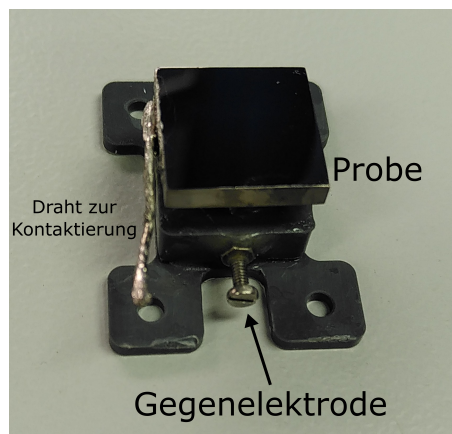
Abb. 4.15: Elektrolytzelle mit Membranprobe. Ein Draht wird an die Seite gelötet, um Krokodilklemmen mit der Probe zu kontaktieren, ohne die Probenoberfläche zu beschädigen.
