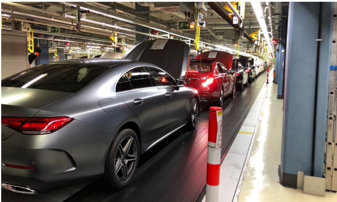
Abbildung 29: Automatischer Teil des statischen E/E-Tests in Halle 36
