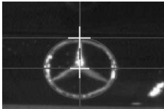
Abbildung 62: Der Mercedes-Stern als Kalibrierreferenz [Que20]
